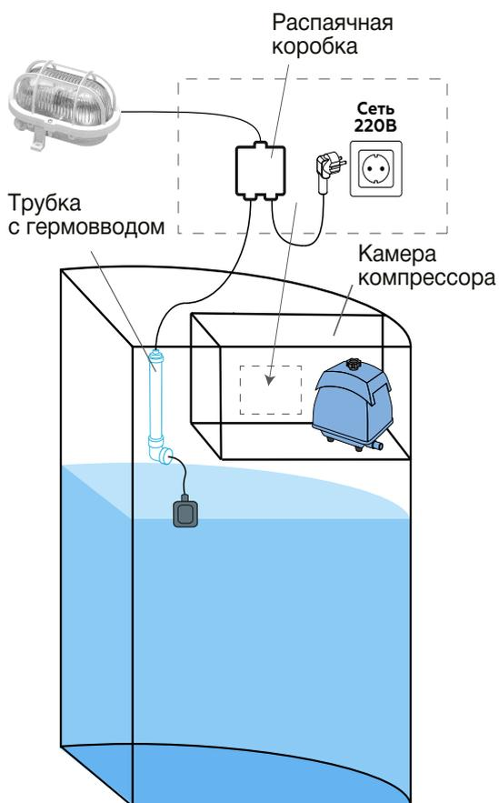
1. Трубка с гермовводом крепится вертикально на внутреннюю перегородку станции с помощью клипс, так чтобы уровень воды находился ниже камеры компрессора.
